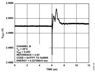
Figure 27. Digital-to-Analog Glitch Impulse
