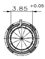
LASER WELDED (LINE) \_/ Laserschweissung (Linie)
