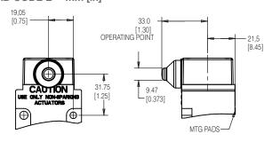
Figure 11. MICRO SWITCH™ LSX SERIES SIDE ROLLER PLUNGER, HEAD CODE F • mm [in]
