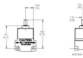
Figure 8. MICRO SWITCH™ LSX SERIES TOP ROLLER PLUNGER, HEAD CODE D • mm [in]
