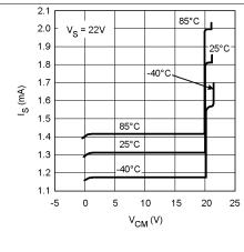
Figure 10. I<sub>S</sub> vs. V<sub>CM</sub>
