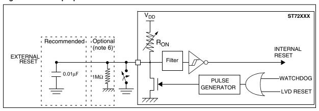
Figure 78. RESET pin protection when LVD is disabled. 1)2)3)4)
