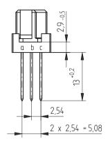
Anschluß 0,6 x 0,6 mm / terminal 0,6 x 0,6 mm Isolierwerkstoff / housing material : PBT GF30
