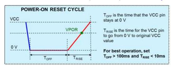
Figure 16. Power-On Reset Cycle
