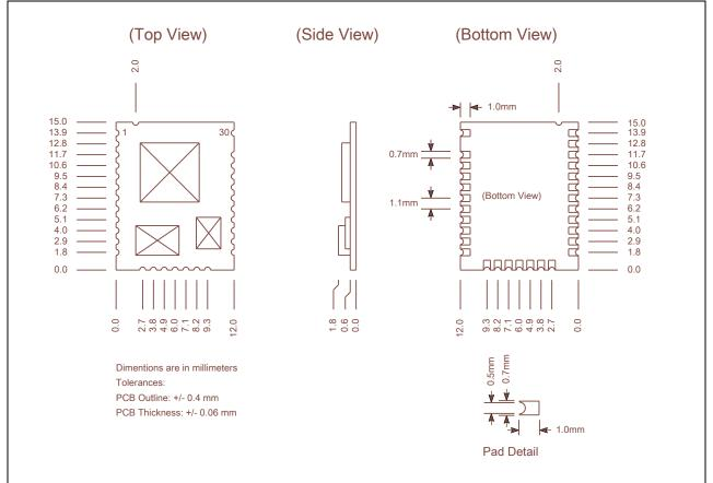
FIGURE 1-10: BM77SPP03MC2 RECOMMEDED PCB FOOTPRINT
