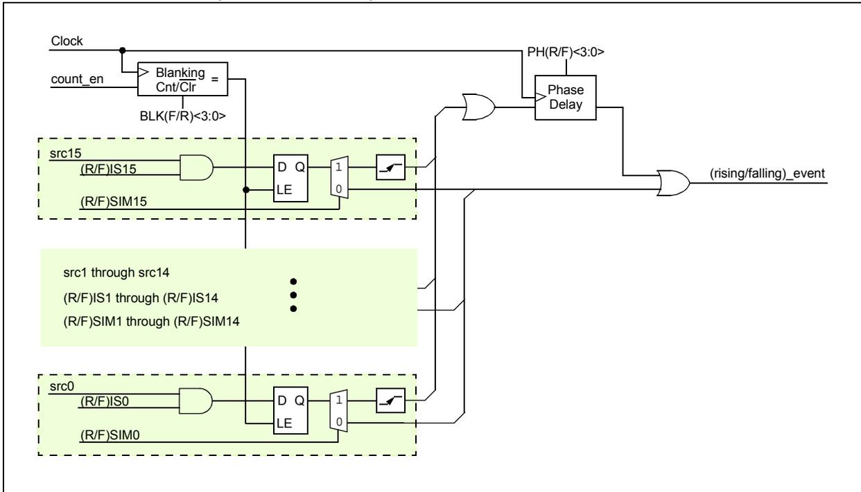
**FIGURE 27-8: COG (RISING/FALLING) DEAD-BAND BLOCK**
