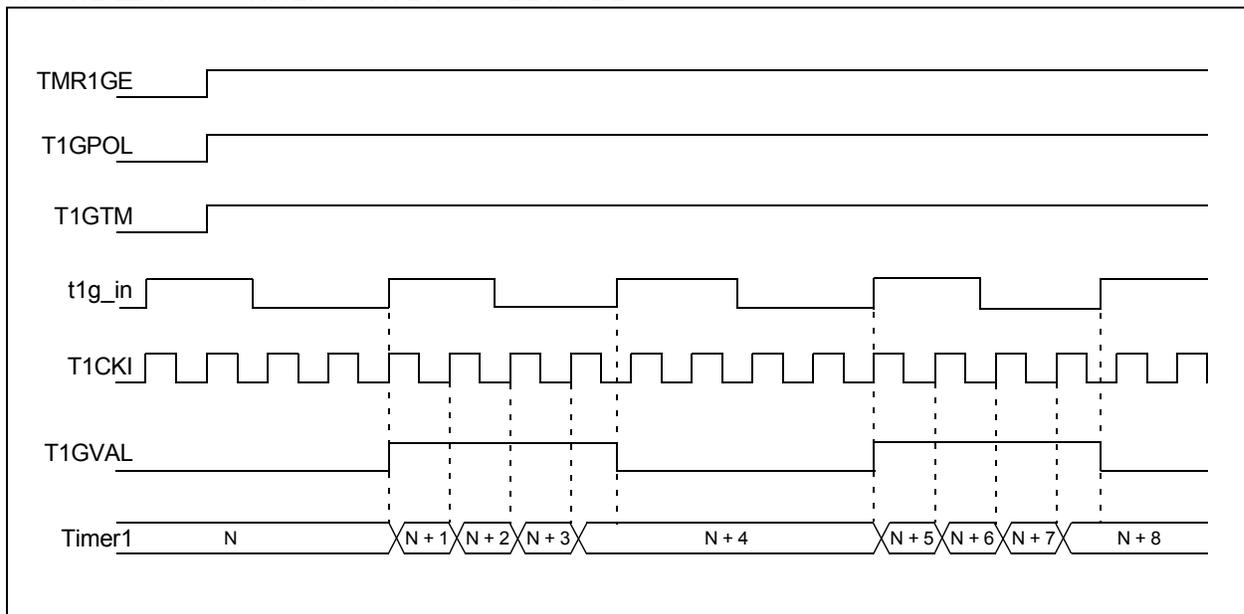
**FIGURE 22-5: TIMER1 GATE SINGLE-PULSE MODE**
