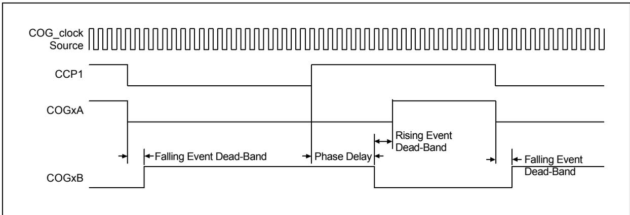
**FIGURE 27-11: PUSH-PULL MODE COG OPERATION WITH CCP1**
