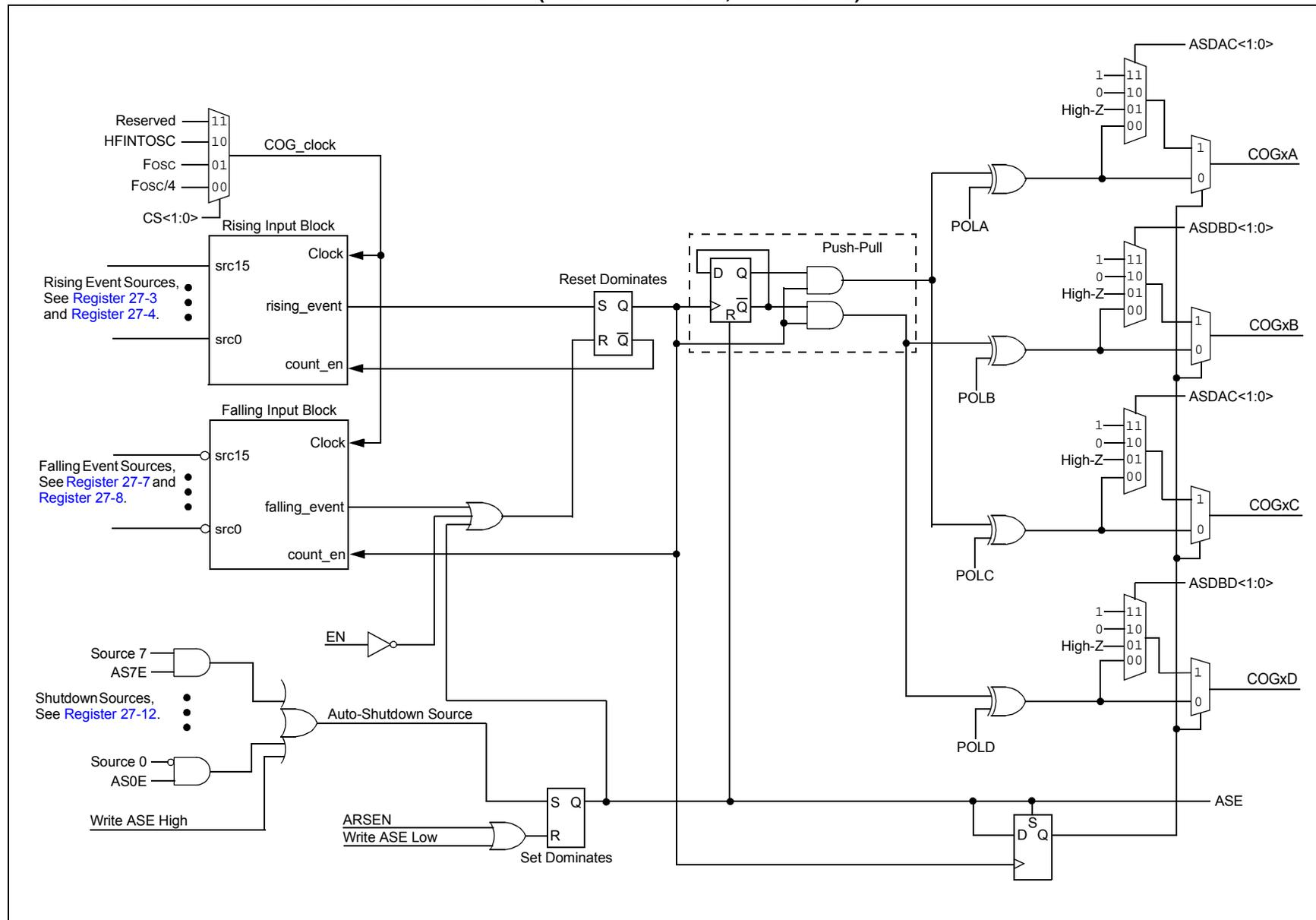
**FIGURE 27-7: COG (RISING/FALLING) INPUT BLOCK**
