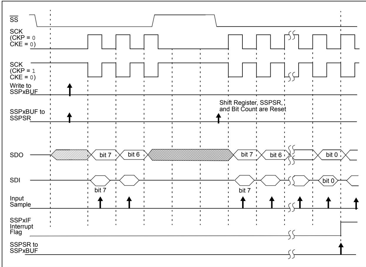
**FIGURE 32-9: SPI MODE WAVEFORM (SLAVE MODE WITH CKE = 0)**
