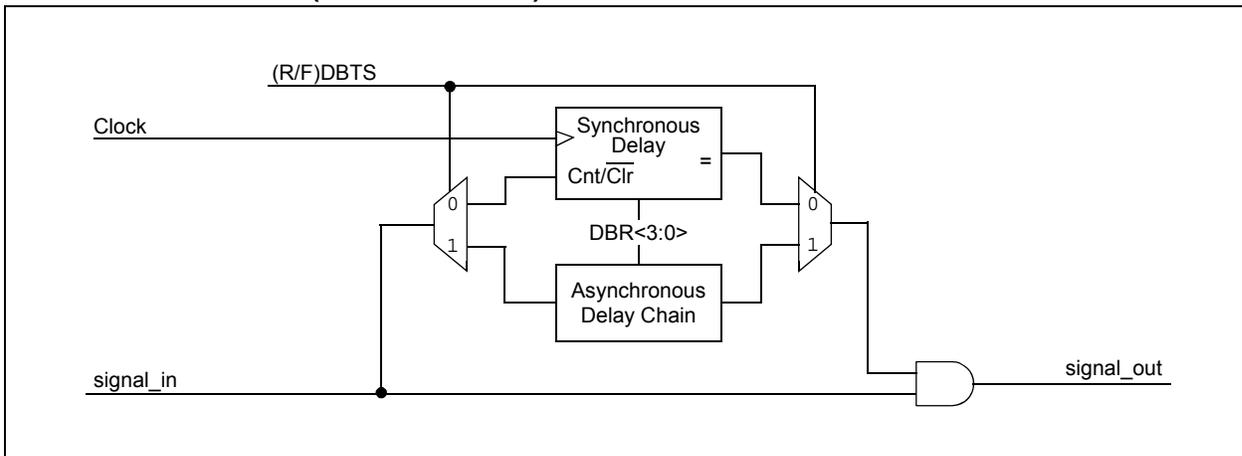
**FIGURE 27-9: TYPICAL HALF-BRIDGE MODE COG OPERATION WITH CCP1**
