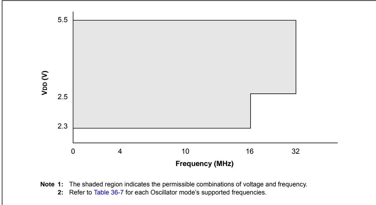
**FIGURE 36-2: VOLTAGE FREQUENCY GRAPH,  $-40^{\circ}\text{C} \leq T_A \leq +125^{\circ}\text{C}$ , PIC16LF1764/5/8/9 ONLY**
