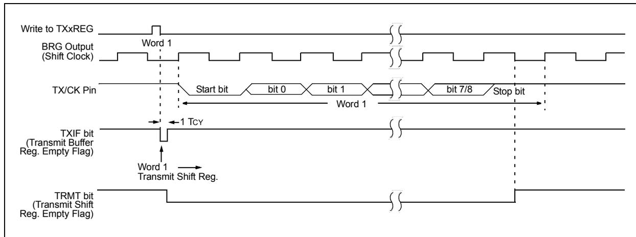
**FIGURE 33-4: ASYNCHRONOUS TRANSMISSION (BACK-TO-BACK)**
