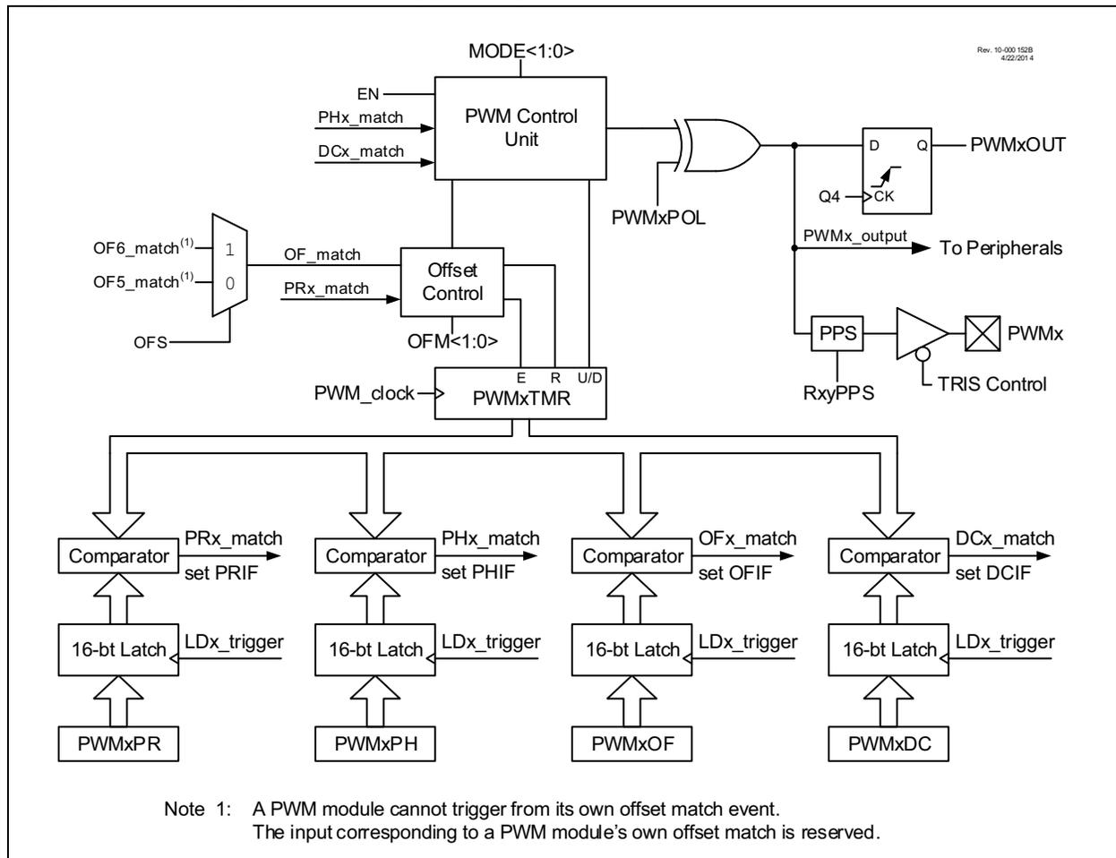
**FIGURE 26-2: LOAD TRIGGER BLOCK DIAGRAM**
