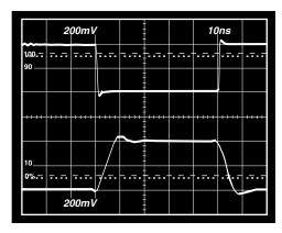
TPC 30. Inverter Small Signal Pulse Response  $\pm 5~V_{\rm S}$ ,  $C_{\rm F}=0~p{\rm F},~R_{\rm L}=150~\Omega$
