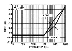
FIGURE 21. PSRR vs FREQUENCY
