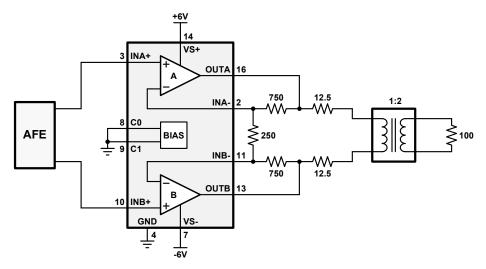
FIGURE 1. TYPICAL OPERATING CIRCUIT
