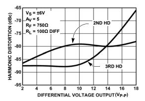
FIGURE 14. HARMONIC DISTORTION AT 10MHz
