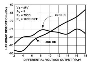
FIGURE 16. HARMONIC DISTORTION AT 17MHz
