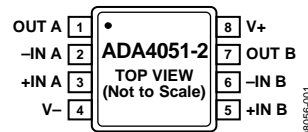
图3. 8引脚MSOP (RM-8)
