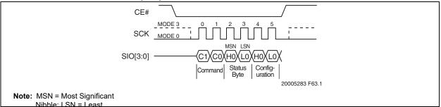
FIGURE 5-31: WRITE-STATUS-REGISTER AND WRITE CONFIGURATION REGISTER SEQUENCE (SPI)
