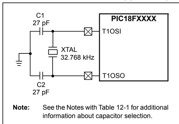
**TABLE 12-1: CAPACITOR SELECTION FOR THE TIMER1 OSCILLATOR<sup>(1,2,3,4)</sup>**
