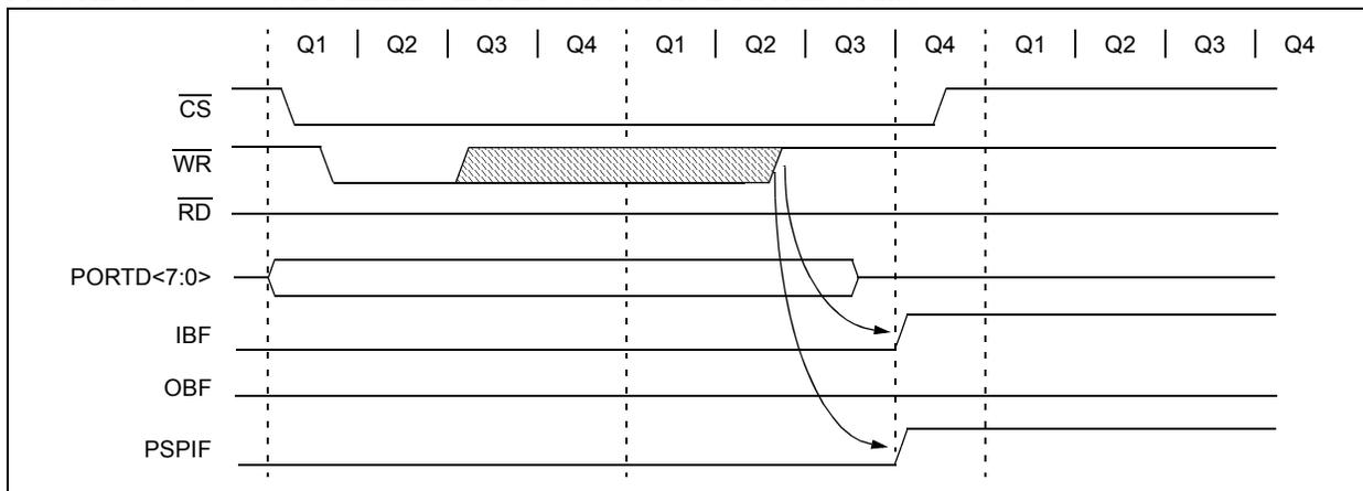
**FIGURE 10-4: PARALLEL SLAVE PORT READ WAVEFORMS**
