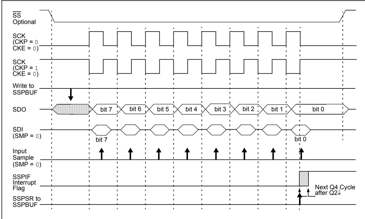
**FIGURE 17-6: SPI MODE WAVEFORM (SLAVE MODE WITH CKE = 1)**
