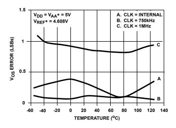
FIGURE 7. OFFSET VOLTAGE vs TEMPERATURE
