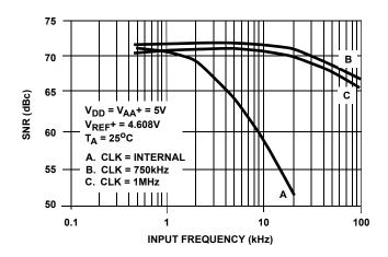
FIGURE 17. SIGNAL NOISE RATIO vs INPUT FREQUENCY
