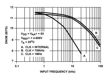
FIGURE 15. EFFECTIVE BITS vs INPUT FREQUENCY
