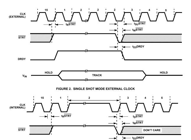
FIGURE 3. SINGLE SHOT MODE INTERNAL CLOCK
