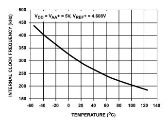
FIGURE 14. INTERNAL CLOCK FREQUENCY vs TEMPERATURE
