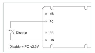
Figure 2 — Module enable/disable
