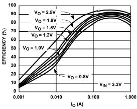
FIGURE 4. EFFICIENCY vs IO (PWM MODE)
