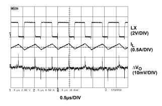
FIGURE 16. PWM STEADY-STATE OPERATION ( $I_0 = 1A$ )
