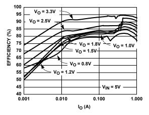
FIGURE 1. EFFICIENCY vs I<sub>O</sub> (PFM/PWM MODE)
