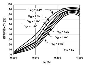
FIGURE 2. EFFICIENCY vs I<sub>O</sub> (PWM MODE)
