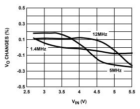
FIGURE 12. LINE REGULATION @ 500mA (PWM MODE)
