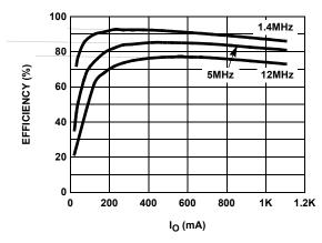
FIGURE 10. EFFICIENCY vs I<sub>O</sub> (PWM MODE)
