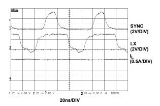
FIGURE 18. EXTERNAL SYNCHRONIZATION TO 12MHz
