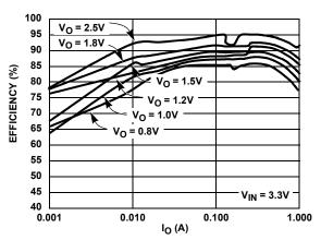
FIGURE 3. EFFICIENCY vs IO (PFM/PWM MODE)
