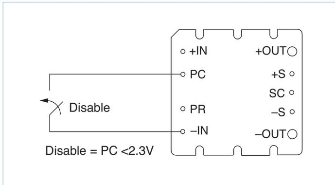
Figure 2 — Module enable/disable
