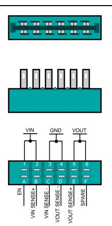
Figure 6. Edge Connector Schematic
