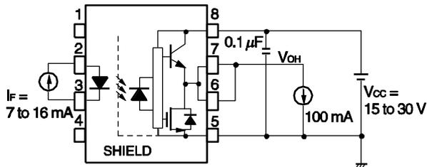
Fig. 4 V<sub>OL</sub> Test Circuit
