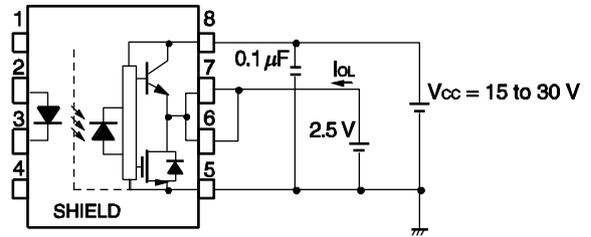
Fig. 3 V<sub>OH</sub> Test Circuit
