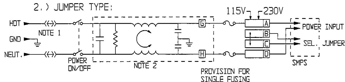
NOTE 1: JUMPERS ARE REQUIRED IF A FILTER OR INTERCONNECTION MODULE IS NOT USED.
