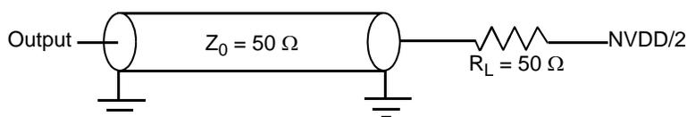
**Figure 32. I<sup>2</sup>C AC Test Load**
