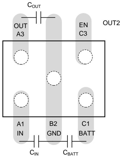
**Figure 19. LP5952 DSBGA Layout Example**
