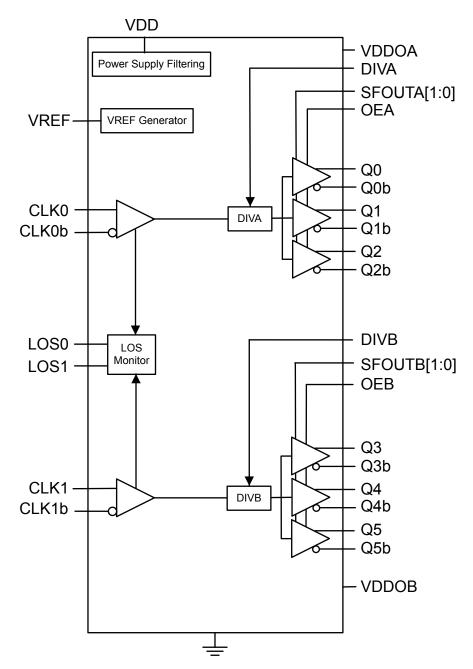
Figure 4.8. Si53308 Block Diagram
