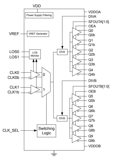
Figure 4.2. Si53302 Block Diagram
