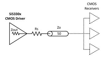
Figure 2.10. LVCMOS Output Termination
