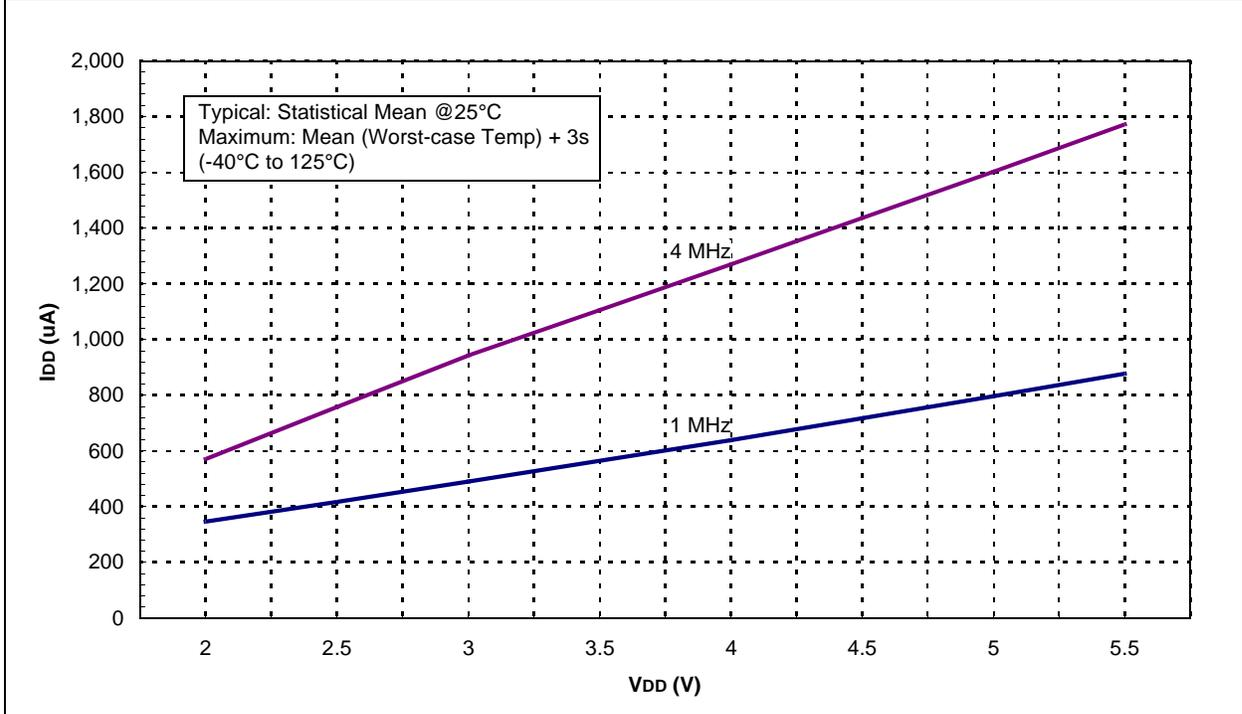
FIGURE 15-9: I<sub>DD</sub> vs. V<sub>DD</sub> OVER F<sub>osc</sub> (LFINTOSC MODE, 31 kHz)
