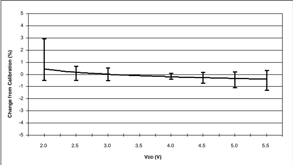
**FIGURE 15-38: TYPICAL HFINTOSC FREQUENCY CHANGE OVER DEVICE V<sub>DD</sub> (85°C)**
