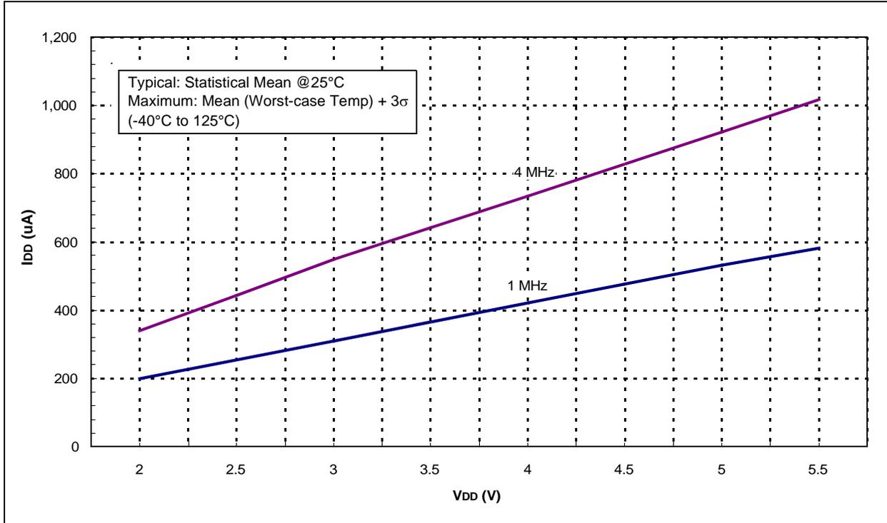
FIGURE 15-8: MAXIMUM I<sub>DD</sub> vs. V<sub>DD</sub> (EXTRC MODE)
