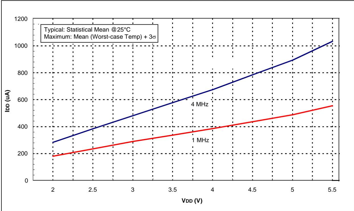
FIGURE 15-6: MAXIMUM I<sub>DD</sub> vs. V<sub>DD</sub> OVER F<sub>osc</sub> (XT MODE)
