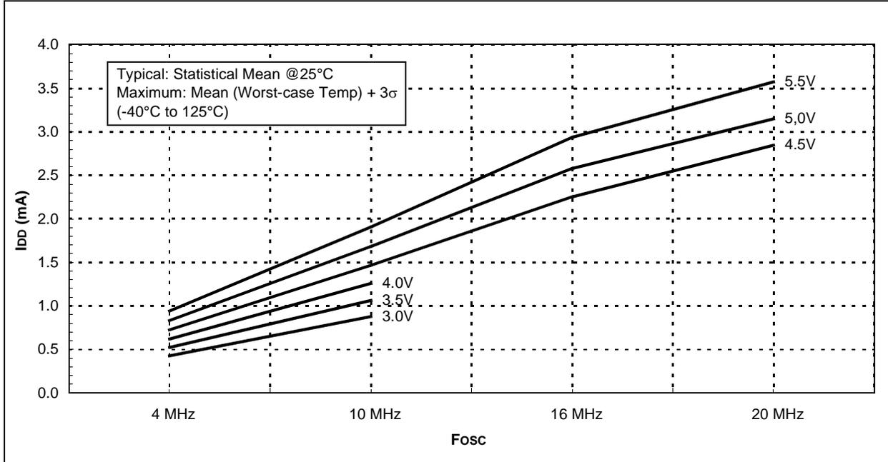
FIGURE 15-4: MAXIMUM I<sub>DD</sub> vs. F<sub>osc</sub> OVER V<sub>DD</sub> (HS MODE)
