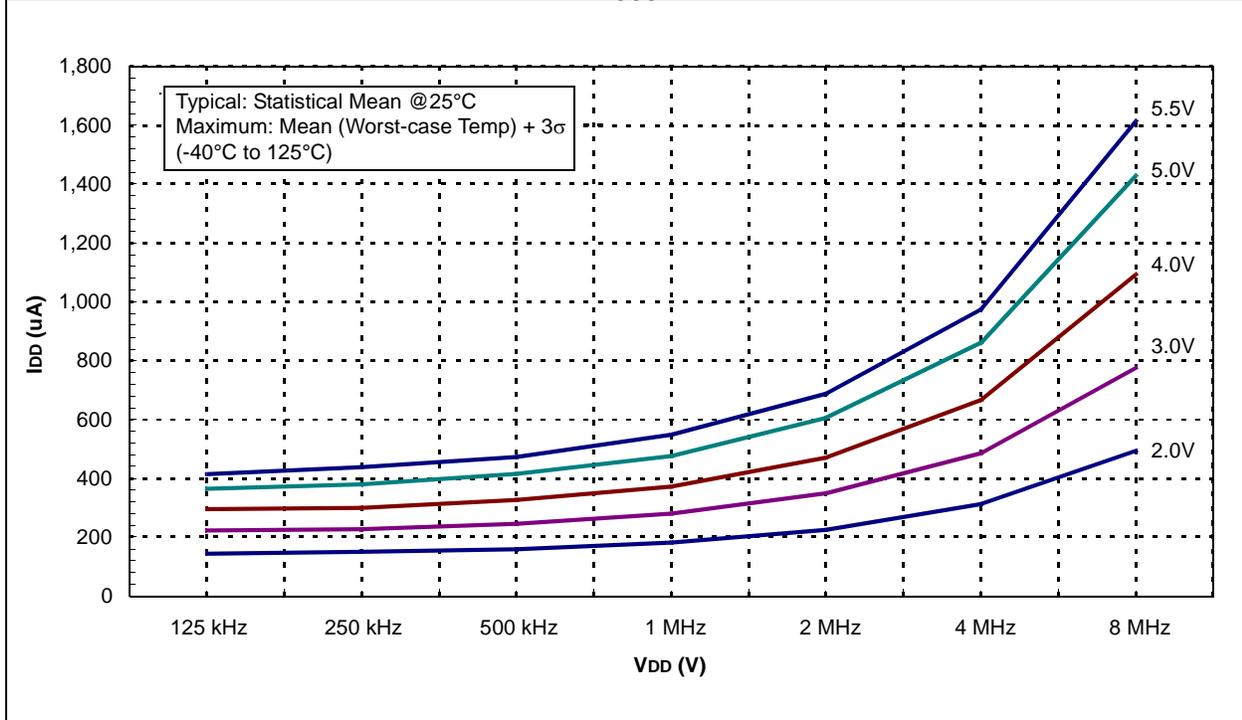
FIGURE 15-12: MAXIMUM I<sub>DD</sub> vs. F<sub>osc</sub> OVER V<sub>DD</sub> (HFINTOSC MODE)
