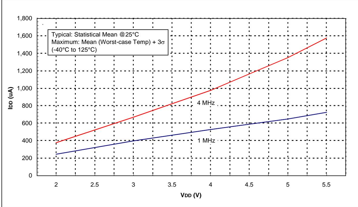
FIGURE 15-7: TYPICAL I<sub>DD</sub> vs. V<sub>DD</sub> OVER F<sub>osc</sub> (EXTRC MODE)
