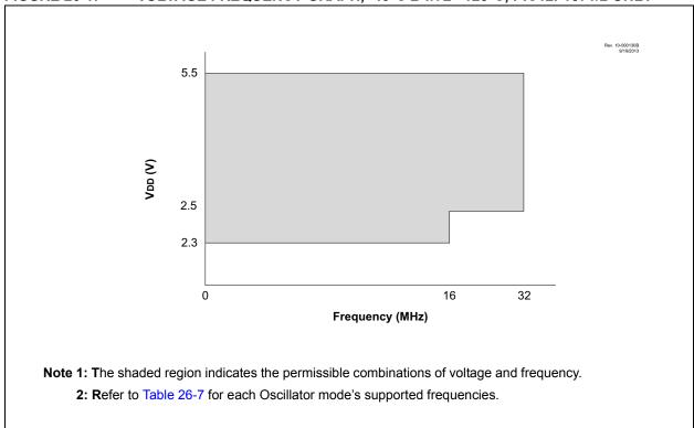
**FIGURE 26-2:** VOLTAGE FREQUENCY GRAPH, -40°C ≤ TA ≤ +125°C, PIC12LF1571/2 ONLY
