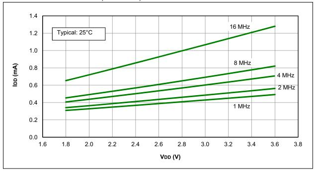
FIGURE 27-18: IDD MAXIMUM, HFINTOSC, PIC12LF1571/2 ONLY
