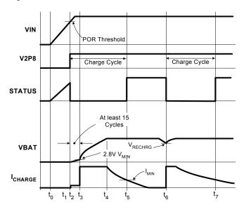
FIGURE 20. OPERATION WAVEFORMS
