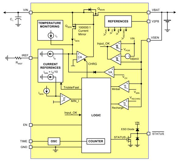
FIGURE 16. BLOCK DIAGRAM
