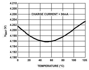
FIGURE 2. CHARGER OUTPUT VOLTAGE vs TEMPERATURE
