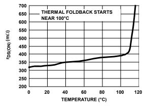
FIGURE 9. r<sub>DS(ON)</sub> vs TEMPERATURE AT 3.7V OUTPUT
