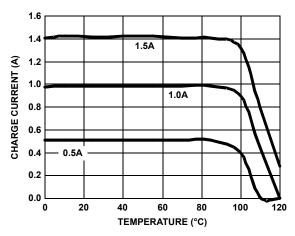
FIGURE 5. CHARGE CURRENT vs AMBIENT TEMPERATURE
