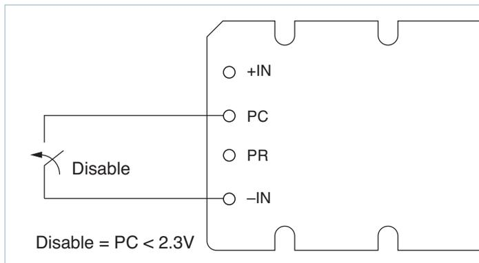
Figure 2 — Module enable/disable
