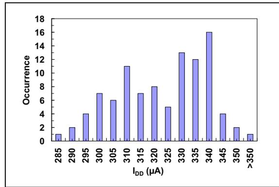
**FIGURE 2-17:**  $I_{DD}$  Histogram ( $V_{DD} = 5.0\text{V}$ ).
