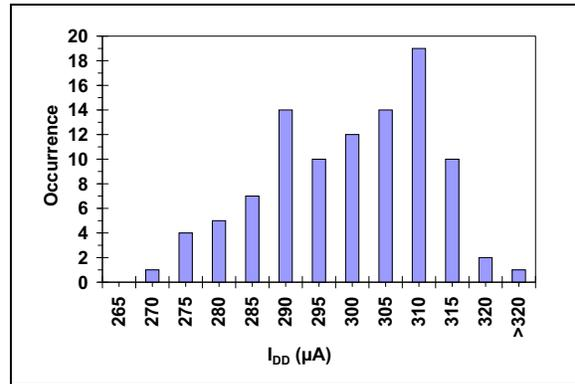
**FIGURE 2-16:**  $I_{DD}$  Histogram ( $V_{DD} = 2.7\text{V}$ ).
