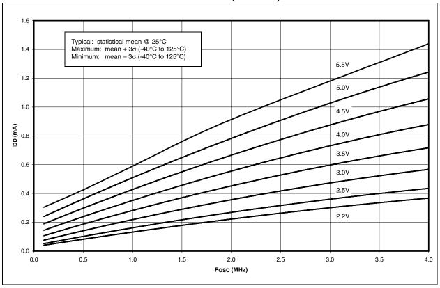
FIGURE 15-4: MAXIMUM IDD vs. Fosc OVER VDD (XT MODE)
