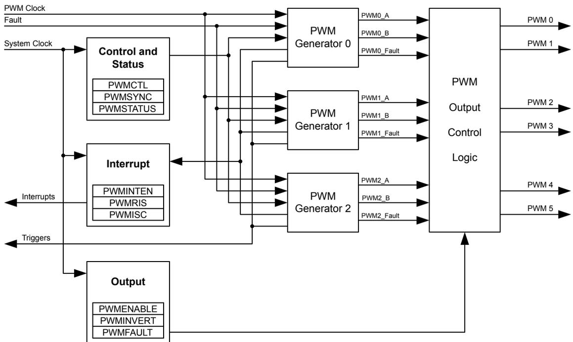
Figure 15-2. PWM Module Block Diagram
