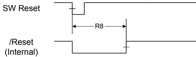
**Figure 19-9. Watchdog Reset Timing**
