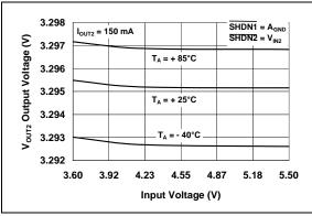
**FIGURE 2-25:**  $V_{OUT2}$  Output Voltage vs. Input Voltage ( $V_{OUT2} = 3.3V$ ).
