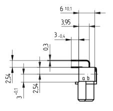
Tauchlötaschluß 0,3 x 0,7 mm / solder terminal 0,3 x 0,7 mm Isolierwerkstoff / housing material : PBT GF30
