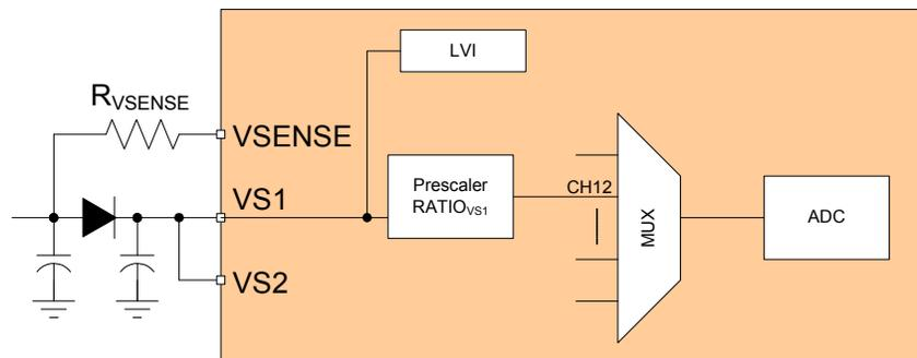
Figure 42. VS1Sense Module
