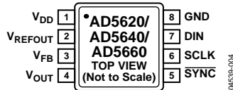
图4. MSOP引脚配置
