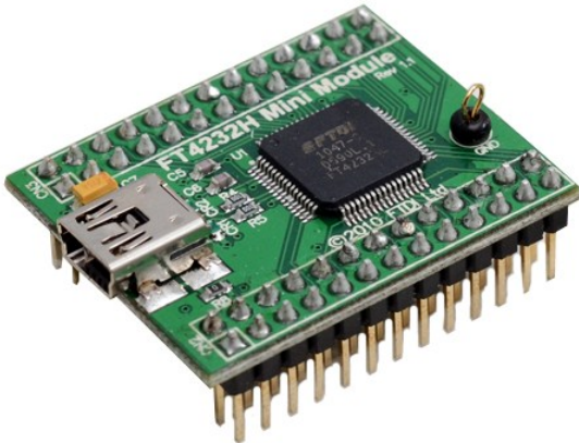
Figure 1.1 - FT4232H Mini Module
