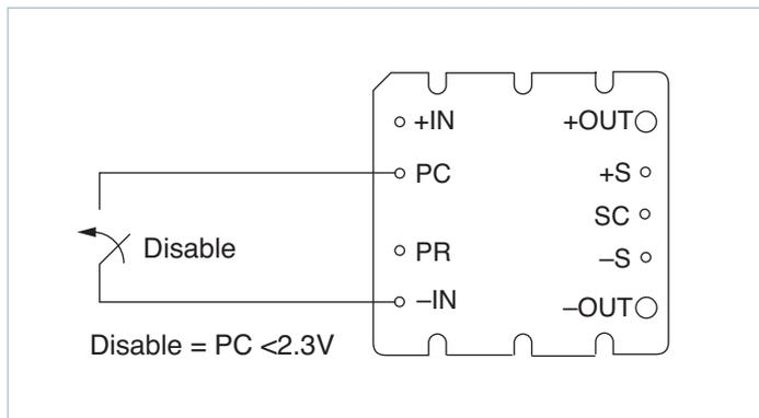
Figure 2 — Module enable/disable
