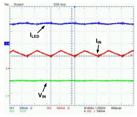
6 serial LEDs,  $T_A$  = 25°C  $I_{LED}$ : 200 mA/DIV,  $I_{IN}$ : 1 A/DIV,  $V_{IN}$ : 10 V/DIV
