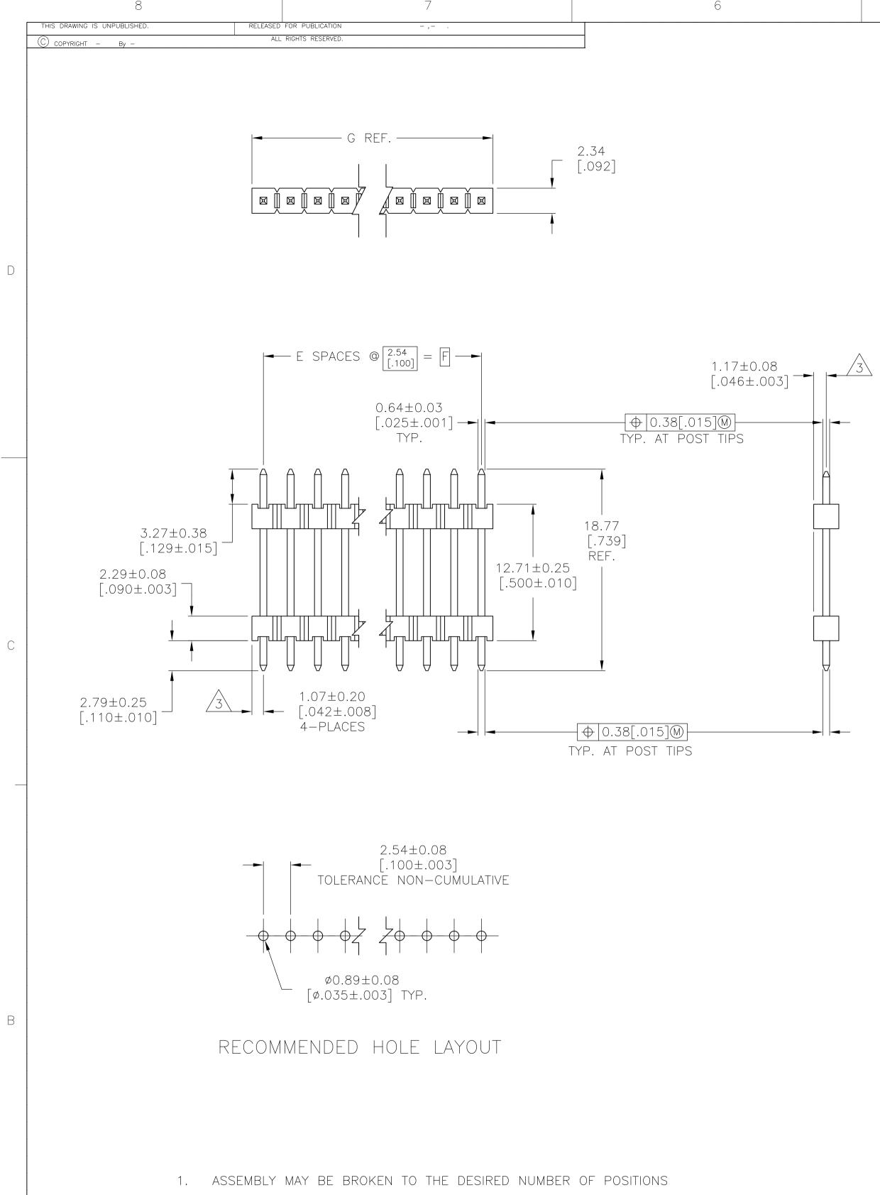
2. TRUE POSITION TOLERANCE OF THE POST TIPS APPLIES WHEN THE HEADER IS HELD FLAT AGAINST THE PRINTED CIRCUIT BOARD
