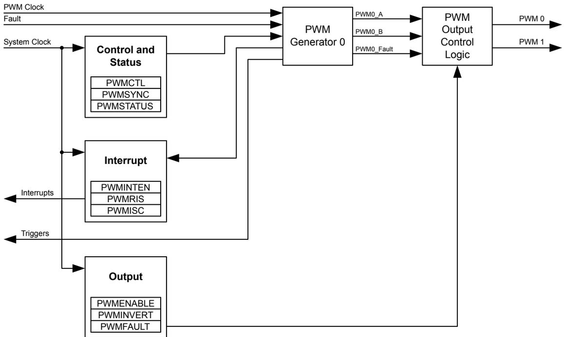
Figure 15-2. PWM Module Block Diagram
