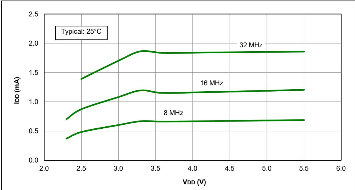
**FIGURE 27-12: I<sub>DD</sub> MAXIMUM, EC OSCILLATOR, HIGH-POWER MODE, PIC12F1571/2 ONLY**
