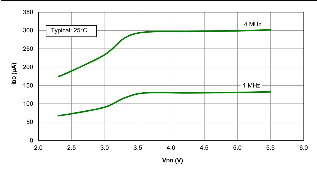
**FIGURE 27-8: I<sub>DD</sub> MAXIMUM, EC OSCILLATOR, MEDIUM POWER MODE, PIC12F1571/2 ONLY**
