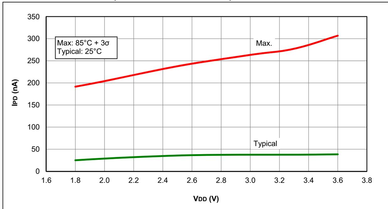
FIGURE 27-22: I<sub>PD</sub> BASE, LOW-POWER SLEEP MODE, PIC12F1571/2 ONLY
