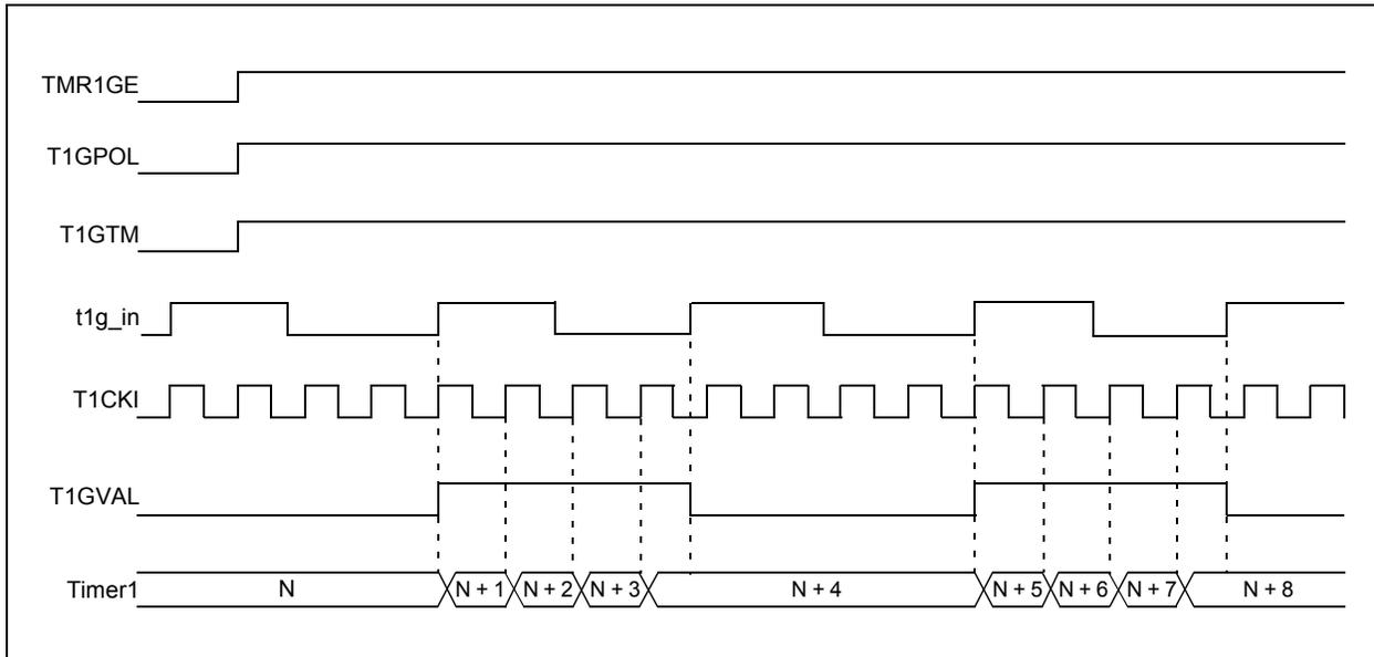
FIGURE 19-5: TIMER1 GATE SINGLE-PULSE MODE
