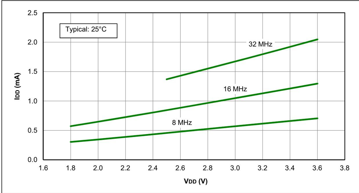
FIGURE 27-10: I<sub>DD</sub> MAXIMUM, EC OSCILLATOR, HIGH-POWER MODE, PIC12LF1571/2 ONLY
