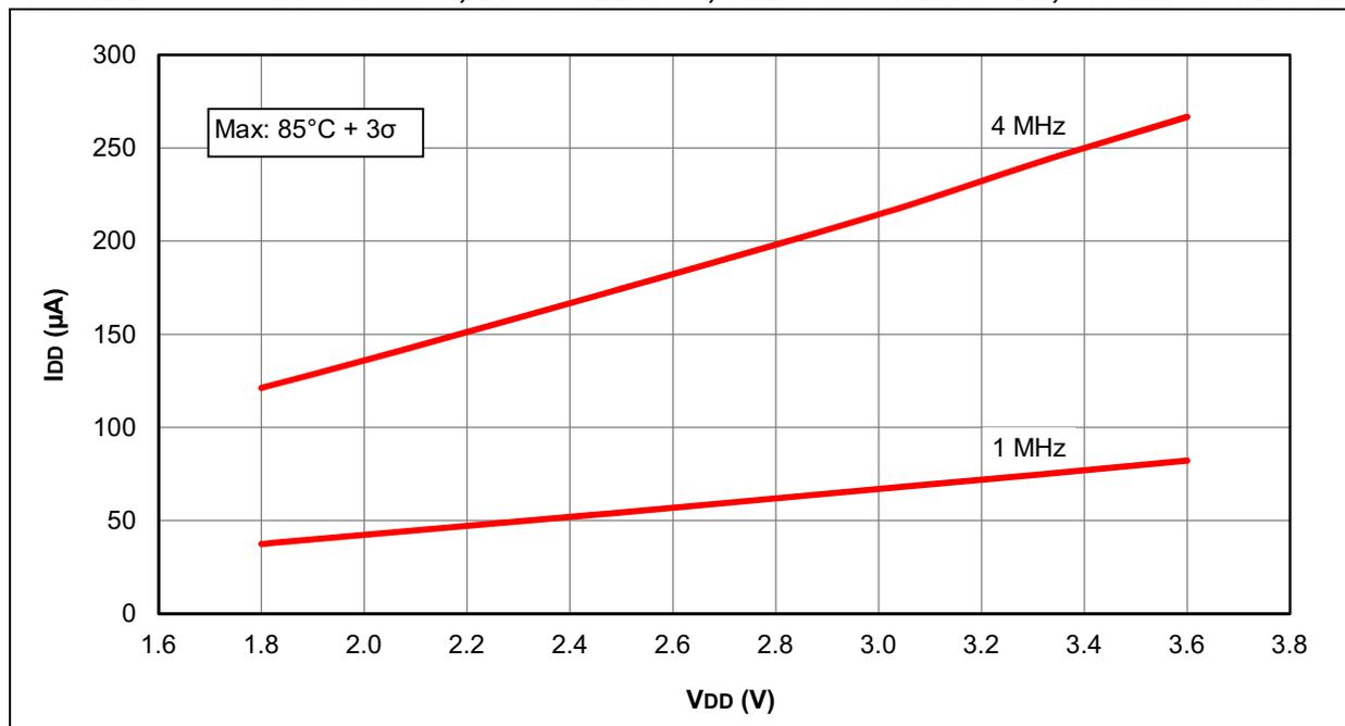
**FIGURE 27-7: I<sub>DD</sub> TYPICAL, EC OSCILLATOR, MEDIUM POWER MODE, PIC12F1571/2 ONLY**
