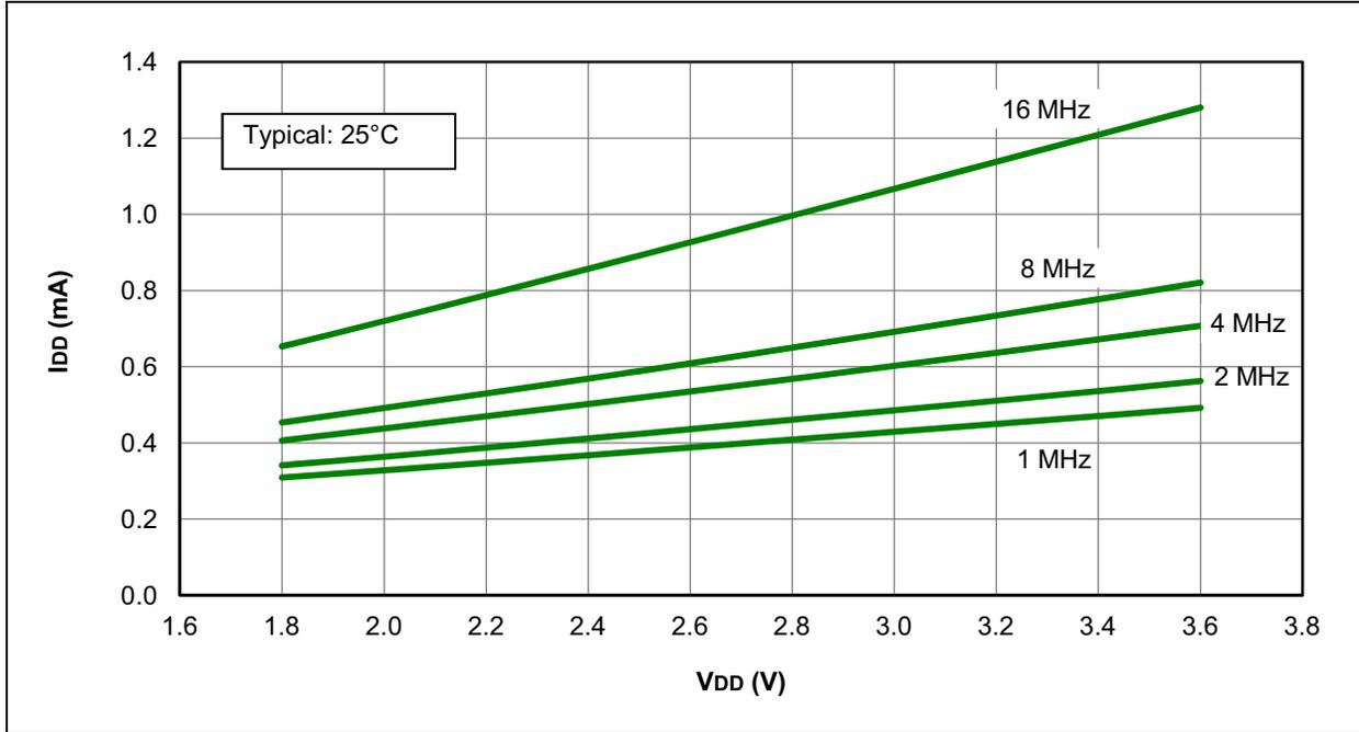
FIGURE 27-18: I<sub>DD</sub> MAXIMUM, HFINTOSC, PIC12LF1571/2 ONLY
