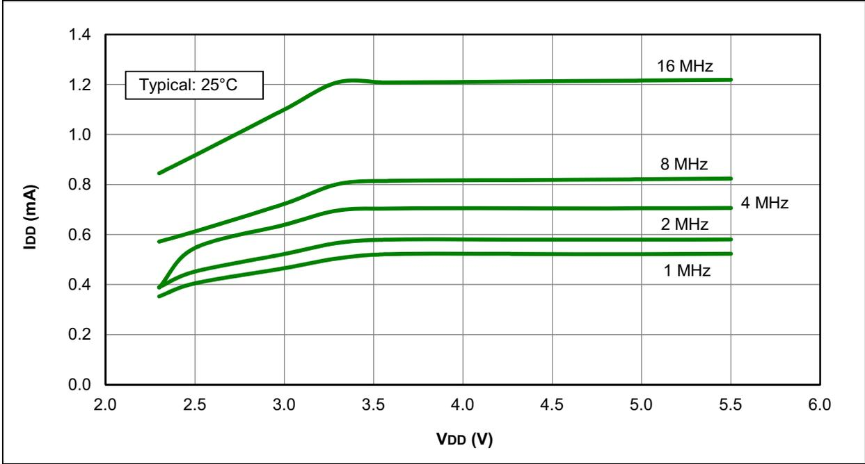
**FIGURE 27-20: I<sub>DD</sub> MAXIMUM, HFINTOSC, PIC12F1571/2 ONLY**
