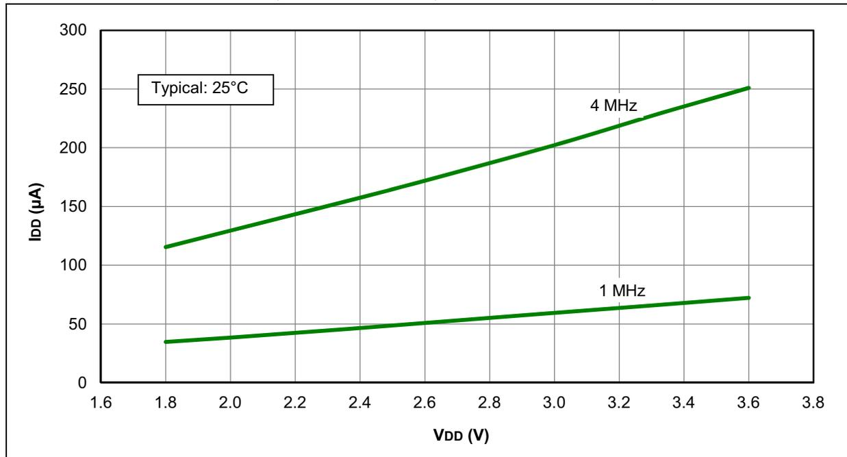
FIGURE 27-6: I<sub>DD</sub> MAXIMUM, EC OSCILLATOR, MEDIUM POWER MODE, PIC12LF1571/2 ONLY
