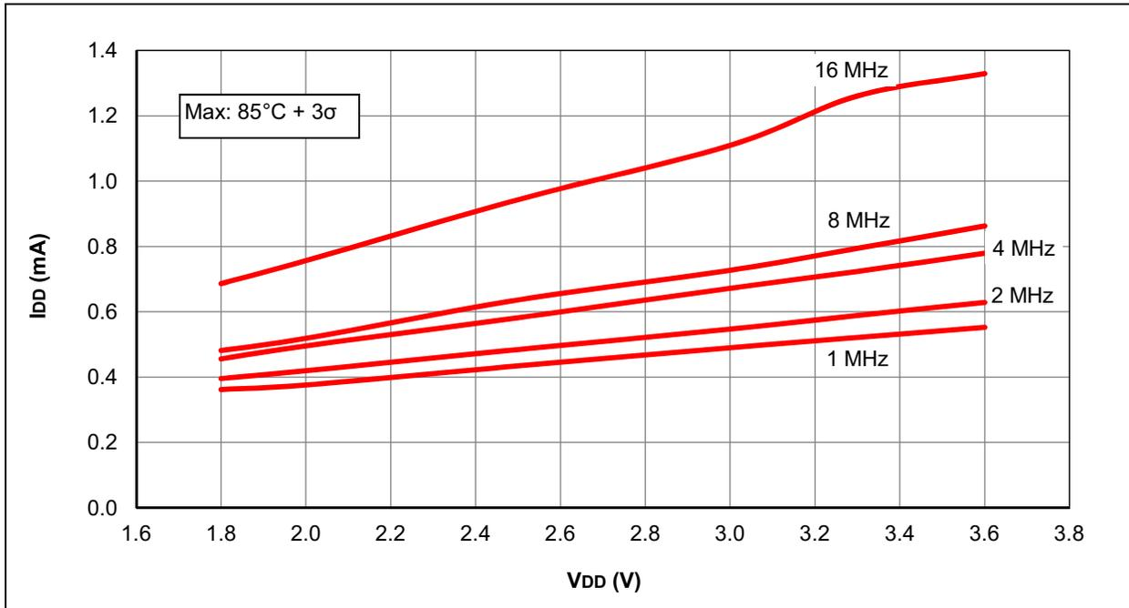
**FIGURE 27-19: I<sub>DD</sub> TYPICAL, HFINTOSC, PIC12F1571/2 ONLY**
