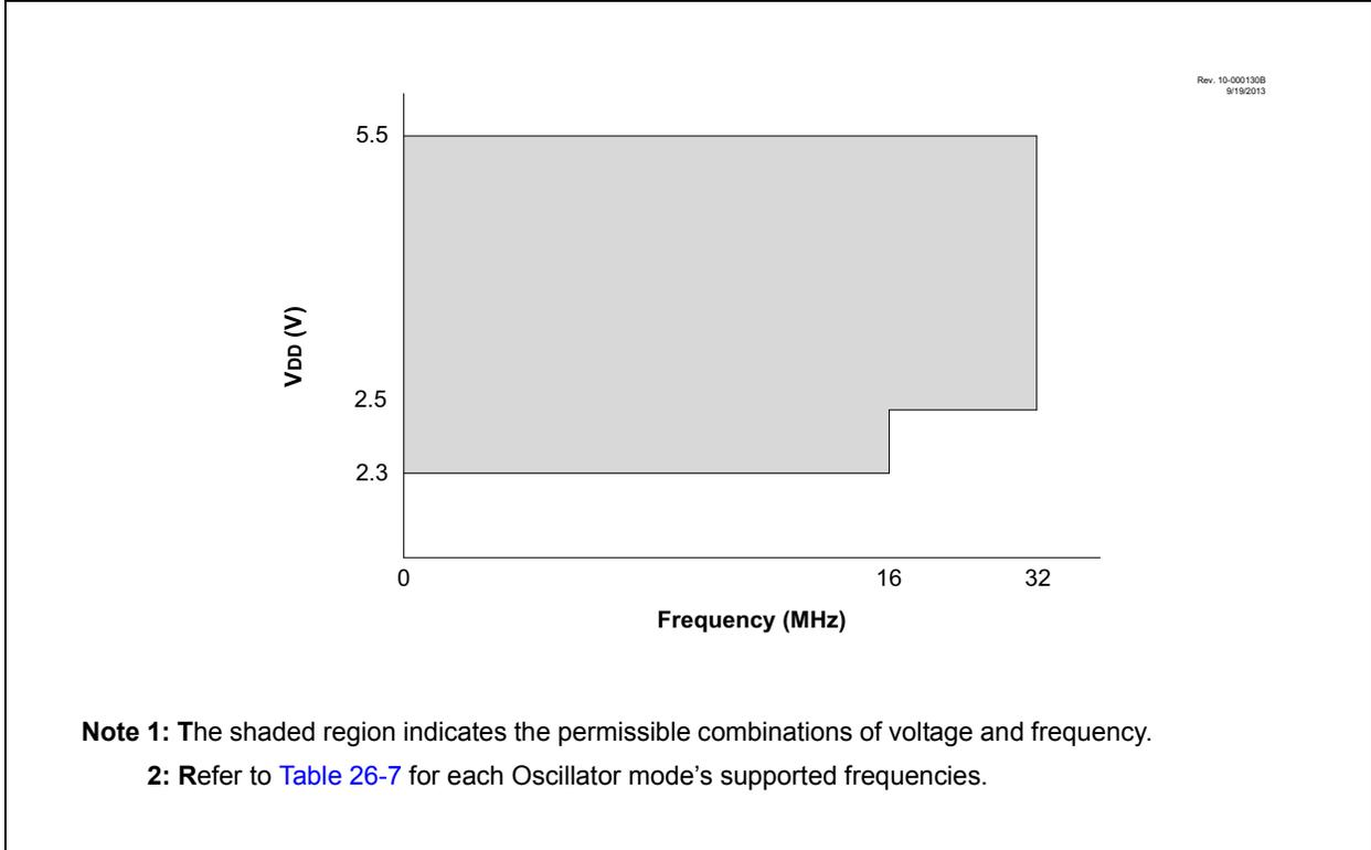
**FIGURE 26-2: VOLTAGE FREQUENCY GRAPH,  $-40^{\circ}\text{C} \leq T_A \leq +125^{\circ}\text{C}$ , PIC12LF1571/2 ONLY**
