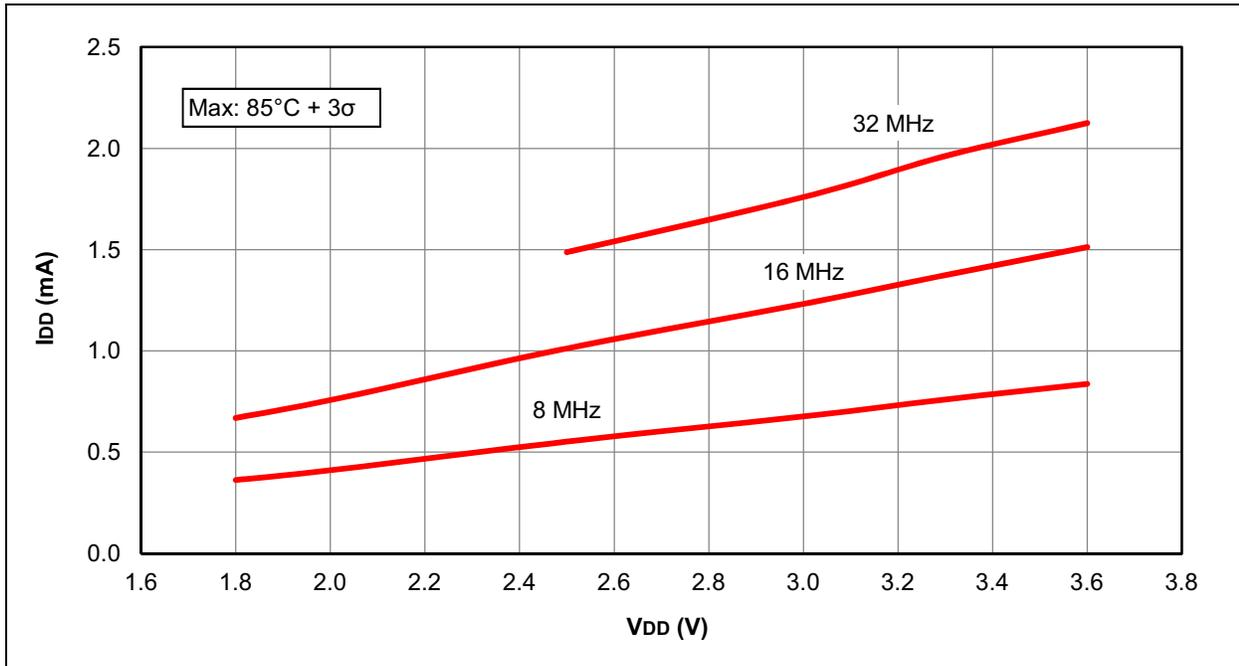
**FIGURE 27-11: I<sub>DD</sub> TYPICAL, EC OSCILLATOR, HIGH-POWER MODE, PIC12F1571/2 ONLY**
