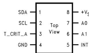
Figure 2. SOIC-8 or VSSOP Package
