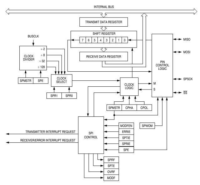
Figure 15-2. SPI Module Block Diagram
