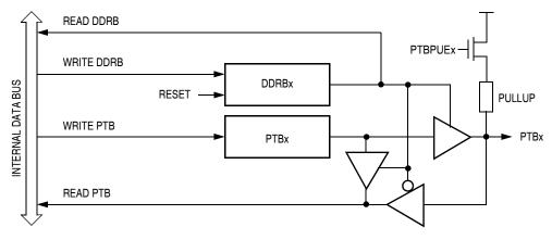
Figure 12-7. Port B I/O Circuit
