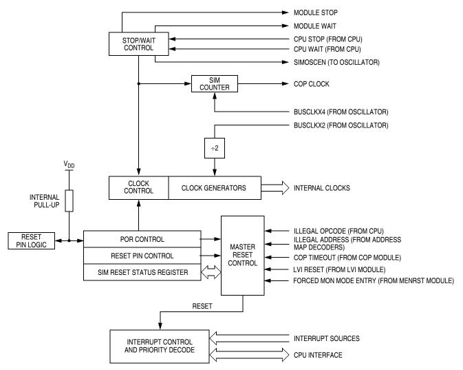
Figure 14-1. SIM Block Diagram
