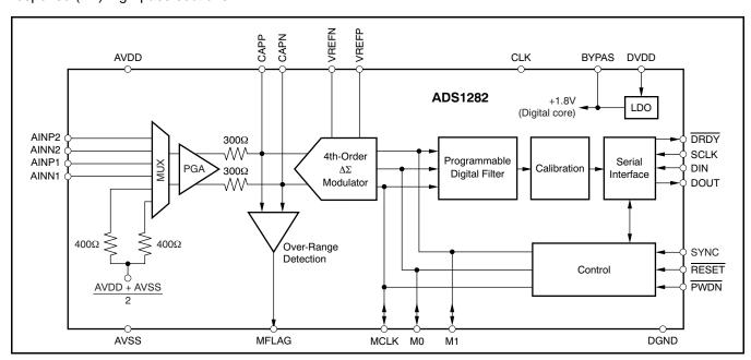
Figure 25. ADS1282 Block Diagram
