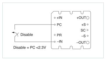
Figure 2 — Module enable/disable
