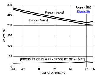
FIGURE 14. DRIVER SKEW vs TEMPERATURE (ISL83483, ISL83488)
