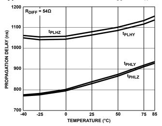
FIGURE 13. DRIVER PROPAGATION DELAY vs TEMPERATURE (ISL83483, ISL83488)
