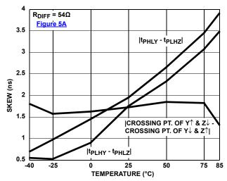
FIGURE 16. DRIVER SKEW vs TEMPERATURE (ISL83485, ISL84390, ISL83491)
