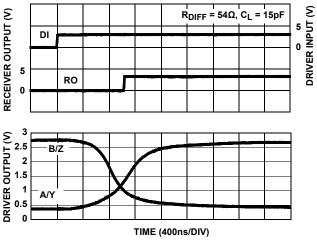
FIGURE 17. DRIVER AND RECEIVER WAVEFORMS, LOW TO HIGH (ISL83483, ISL83488)
