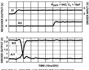
FIGURE 19. DRIVER AND RECEIVER WAVEFORMS, LOW TO HIGH (ISL83485, ISL83490, ISL83491)
