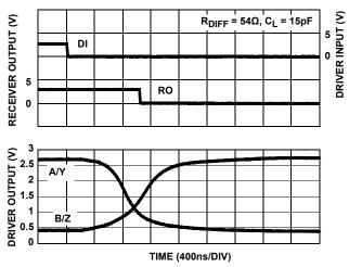
FIGURE 18. DRIVER AND RECEIVER WAVEFORMS, HIGH TO LOW (ISL83483, ISL83488)
