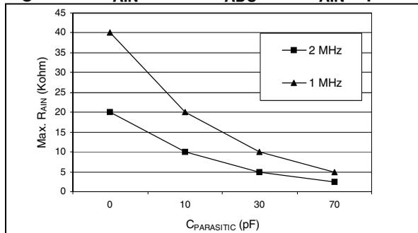
Figure 84. Recommended  $C_{AIN}$  &  $R_{AIN}$  values.<sup>2)</sup>
