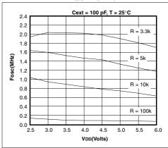
FIGURE 23-7: TYPICAL RC OSCILLATOR FREQUENCY vs. VDD
