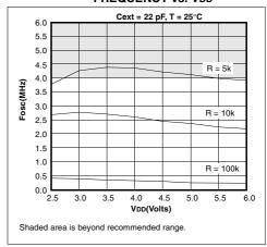
FIGURE 23-6: TYPICAL RC OSCILLATOR FREQUENCY vs. VDD
