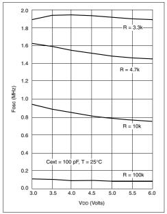
FIGURE 16-4: TYPICAL RC OSCILLATOR FREQUENCY vs. VDD
