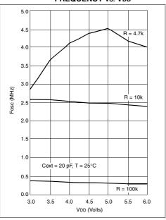
FIGURE 16-3: TYPICAL RC OSCILLATOR FREQUENCY vs. VDD
