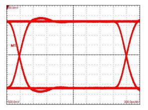
Horizontal Scale= 200 ps/div LVPECL-to-LVDS Figure 42. SN65LVDS100 Mbps, 2<sup>23</sup> – 1 PRBS
