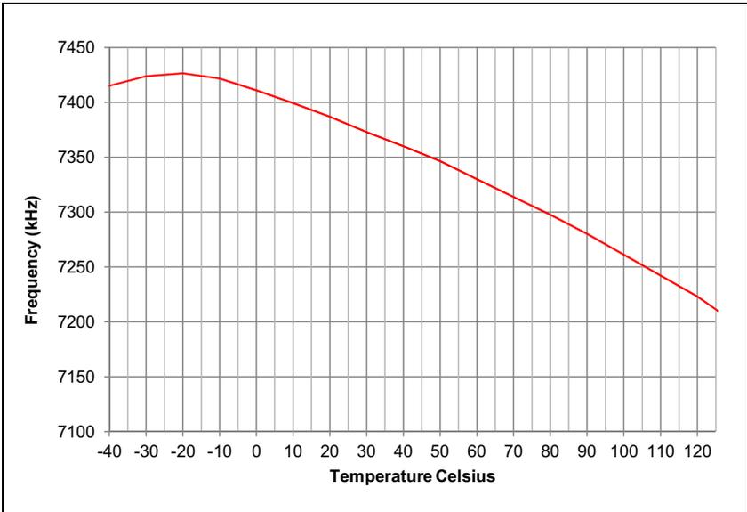
**FIGURE 28-10: TYPICAL LPRC FREQUENCY @ V<sub>DD</sub> = 3.3V**
