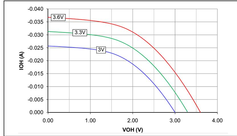
**FIGURE 28-2:  $V_{OH}$  – 4x DRIVER PINS**
